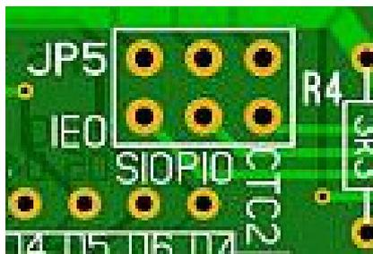
Mit diesem können die **IEO**-Ausgänge von CTC2, SIO und PIO auf die Pins 20,21,22 des CTC1-Steckplatzes gelegt werden. Ein 74LS245 kann dann z.B. unter Ausnutzung des **/CE**-Signals für CTC1 (IO-Adresse 0B0h) zum Auslesen der **IEO**-Signale der Bausteine Verwendung finden. Der Jumper „ohne CTC1“ ist in dem Falle zu setzen.
